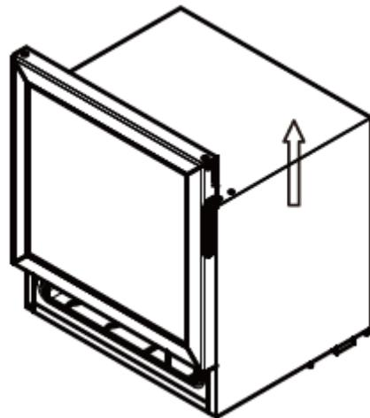
3. Demontujte objímku osy dveří ⑥ na spodní části skleněných dveří, šrouby blokující zarážku dveří ⑧ a zarážku dveří ⑦ a upevněte je na levé straně.
