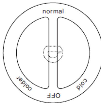
Rozsah nastavení teploty podle stupňů Celsia je 1 °C ~ 10 °C a rozsah nastavení teploty podle stupňů Fahrenheita je 33 °F ~ 50 °F.
